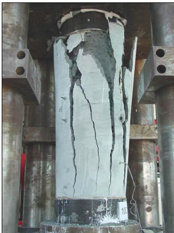
شکل ۶: قلوه کن شدن پوشش بتن در یک ستون با بتن پرمقاومت تحت آزمایش فشاری
