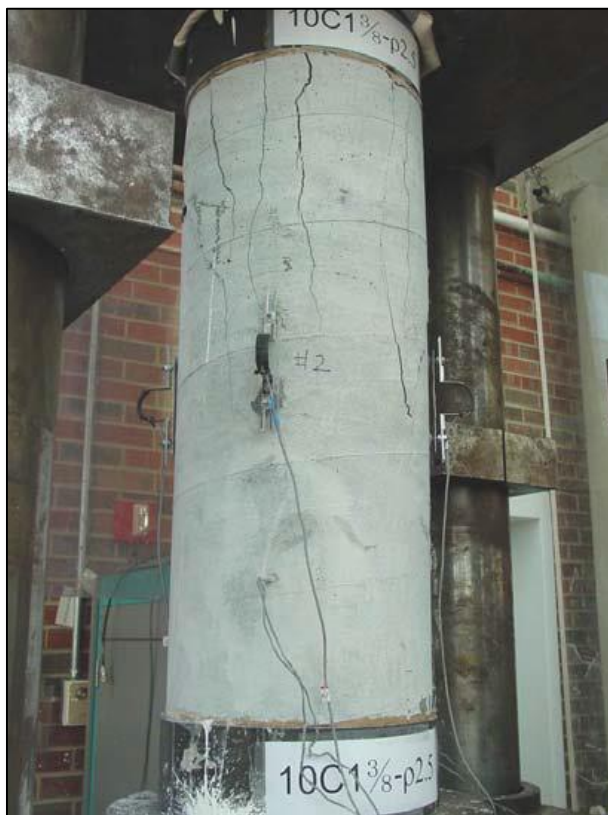
شکل ۱: شروع تشکیل ترک های ریز در ستون با بتن پرمقاومت تحت آزمایش فشاری
